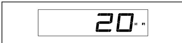
**Niveau de contraste** – Le niveau de contraste actuellement sélectionné s'affichera sur l'écran. Appuyez sur les touches d'augmentation et de diminution Resistance (résistance) pour régler le niveau de contraste.
