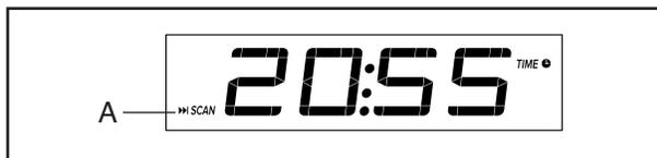
**Pour avancer manuellement dans le cycle de balayage**, appuyez plusieurs fois sur la touche Multi-scan (balayage multiple).
