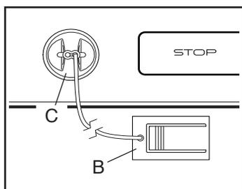
L'affichage s'allumera peu de temps après. **IMPORTANT** : dans une situation d'urgence, la clé peut être tirée hors de la console, ce qui forcera la courroie mobile à ralentir jusqu'à l'arrêt. Testez la pince en reculant doucement de quelques pas ; si la clé n'est pas tirée hors de la console, ajustez la position de la pince.
