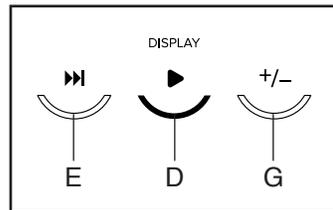
**Le mode balayage** – La console est également équipée d'un mode balayage qui affiche les informations d'entraînement en boucle. **Pour allumer le mode balayage**, appuyez sur la touche Scan (balayage) (E) ; l'indicateur du mode balayage (F) et le mot SCAN s'allumeront alors sur l'écran.
