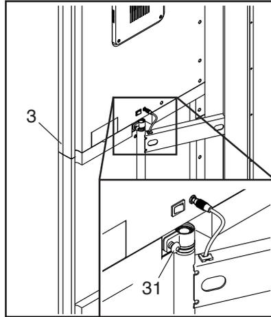
Si la **charnière** ne bouge pas facilement, ou si elle bouge trop librement, le support inférieur de l'armoire doit être ajusté.
