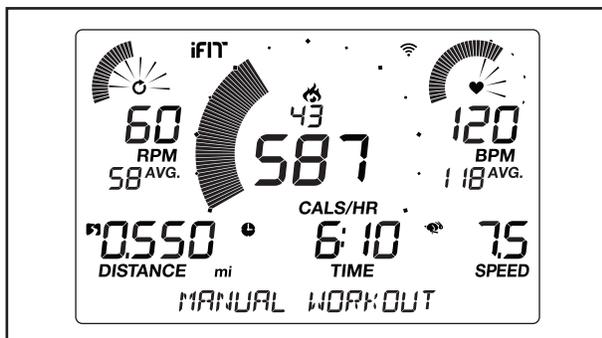
**icône flamme (calories)** – Quand le mode manuel est sélectionné, cet affichage indique la quantité approximative de calories brûlées. Quand un entraînement intégré est sélectionné, cet affichage
