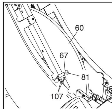
Ensuite, desserrez légèrement les deux Vis M4 x 16mm (107) indiquées, glissez le Capteur Magnétique légèrement plus près ou plus loin de l'Aimant de la Roue d'Inertie, puis resserrez les Vis.
