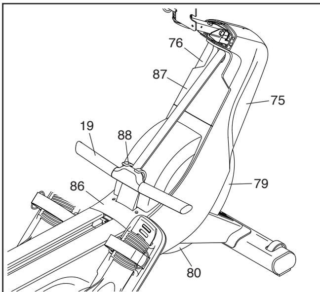
Ensuite, retirez le Boîtier de la Roue d'Inertie (86), le Boîtier de la Sangle (87), le Boîtier Avant (79), le Boîtier Inférieur (80) et les Capots Droit et Gauche (75, 76) du rameur. **Pour trouver les vis qui attachent chaque pièce, référez-vous au SCHÉMA DÉTAILLÉ A à la page 34. IMPORTANT : il y a différentes tailles de vis. Notez bien la taille de la Vis que vous retirez de chaque trou.**
