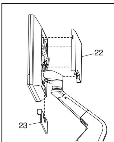
Serrez les quatre Vis M6 x 16mm (96) dans le Socle du Support Arrière (10) jusqu'à ce que le mouvement vers le haut et vers le bas ne semble plus lâche. Inclinez la console vers le haut et vers le bas pour accéder aux Vis. Enfin, réattachez les Boîtiers Supérieur et Inférieur de la Console (22, 23).
